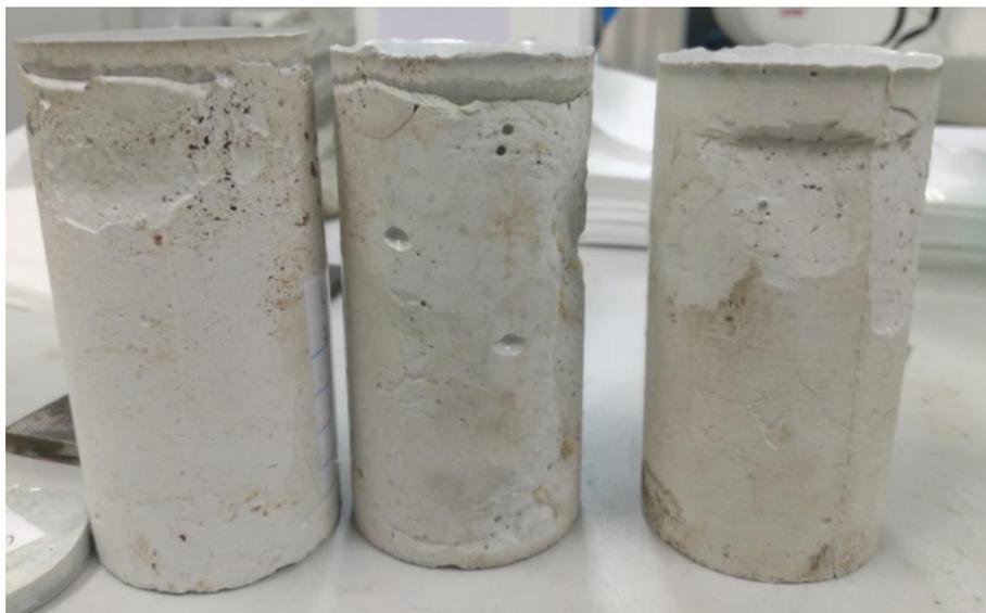
**Figura 18: CPs do GP-1818 feitos com molde de ferro.**
