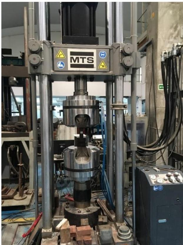
**Figura 39: Máquina de ensaios universais MTS.**
