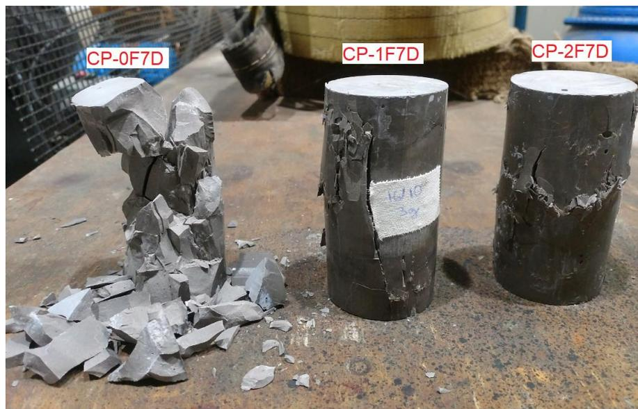
**Figura 44: CPs de 7 dias após o ensaio de compressão.**
