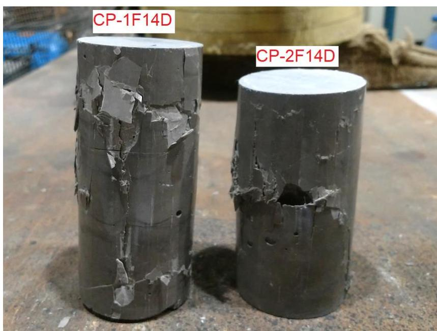
Figura 46: CPs de 14 dias após o ensaio de compressão.
