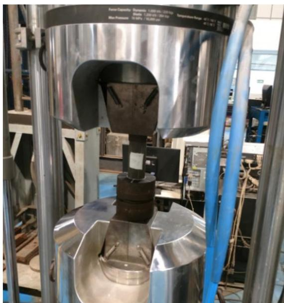
**Figura 40: Corpo de Prova posicionado na máquina de ensaio.**
