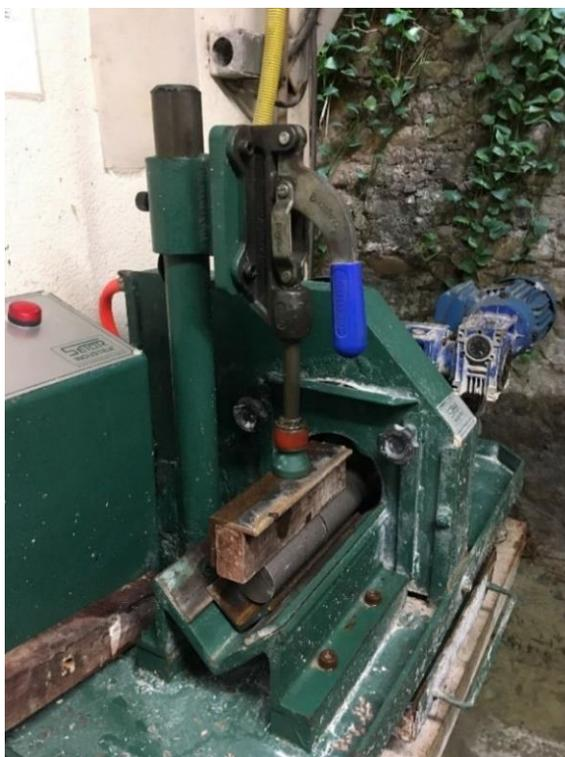
**Figura 37:** Fixação do corpo de prova no equipamento de retificação.
