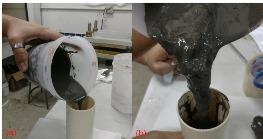
**Figura 29: Moldagem do geopolímero. a) sem fibra e b) com fibra.**
