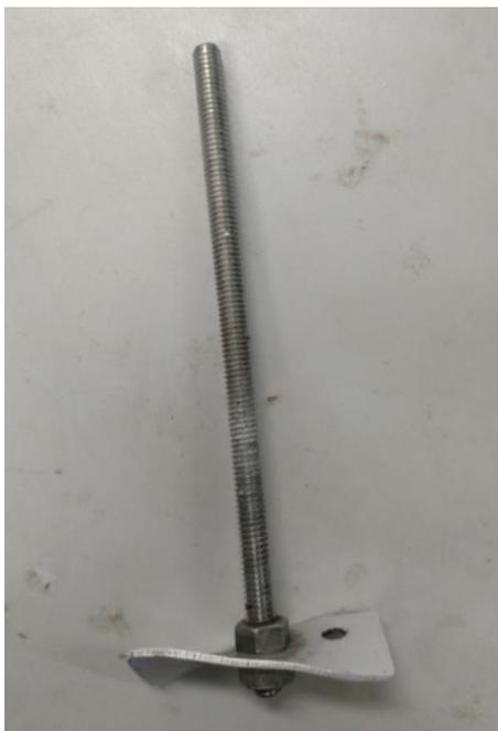
**Figura 22: Haste e hélice do agitador mecânico.**
