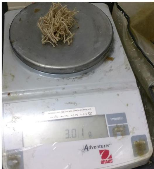
Figura 25: Pesagem das fibras de juta.
