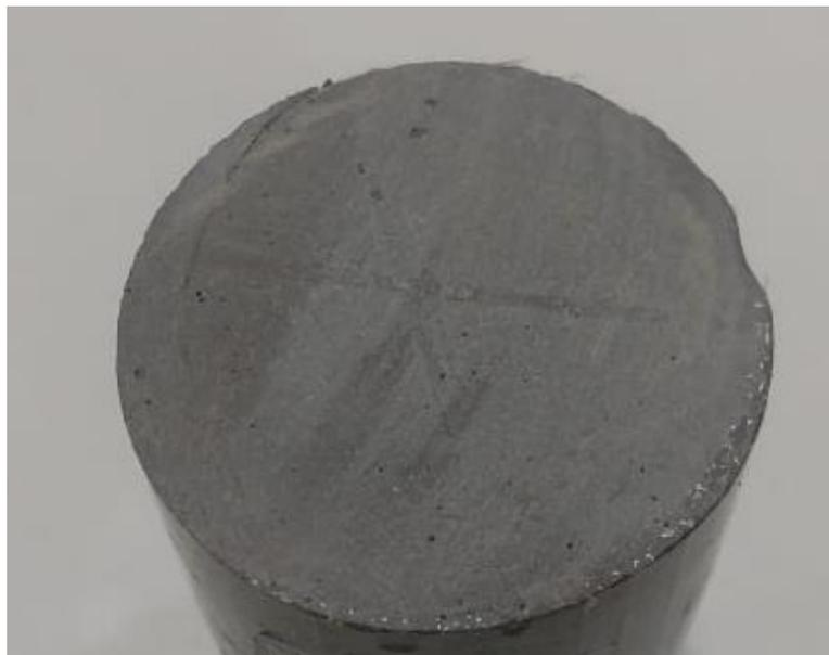
**Figura 38: Base de um corpo de prova após retificação.**
