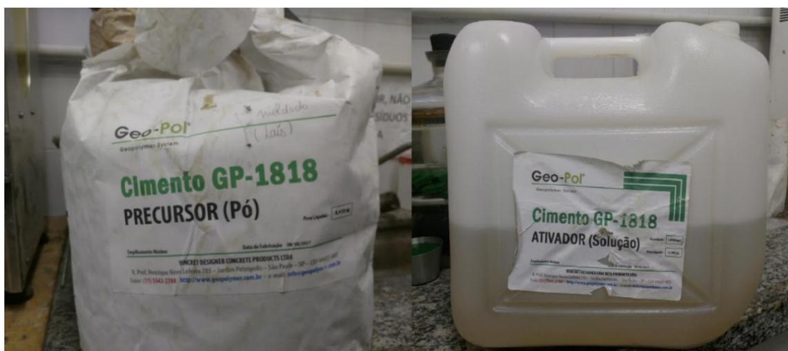
Figura 17: Componentes do Cimento GP-1818.
