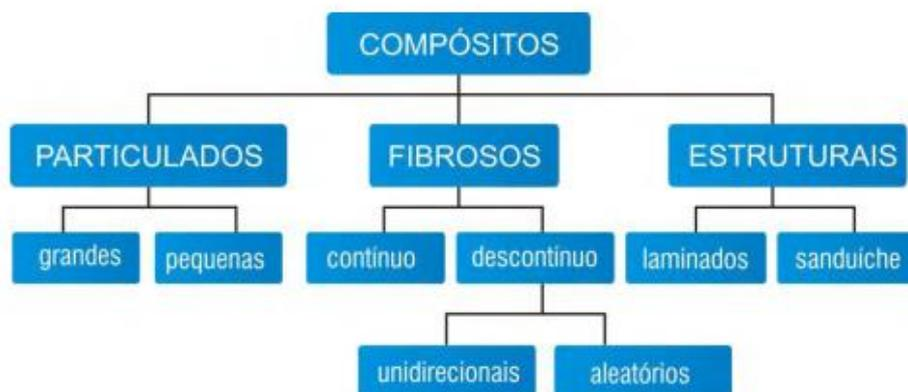
**Figura 8: Classificação de compósitos quanto ao tipo de reforço.**
