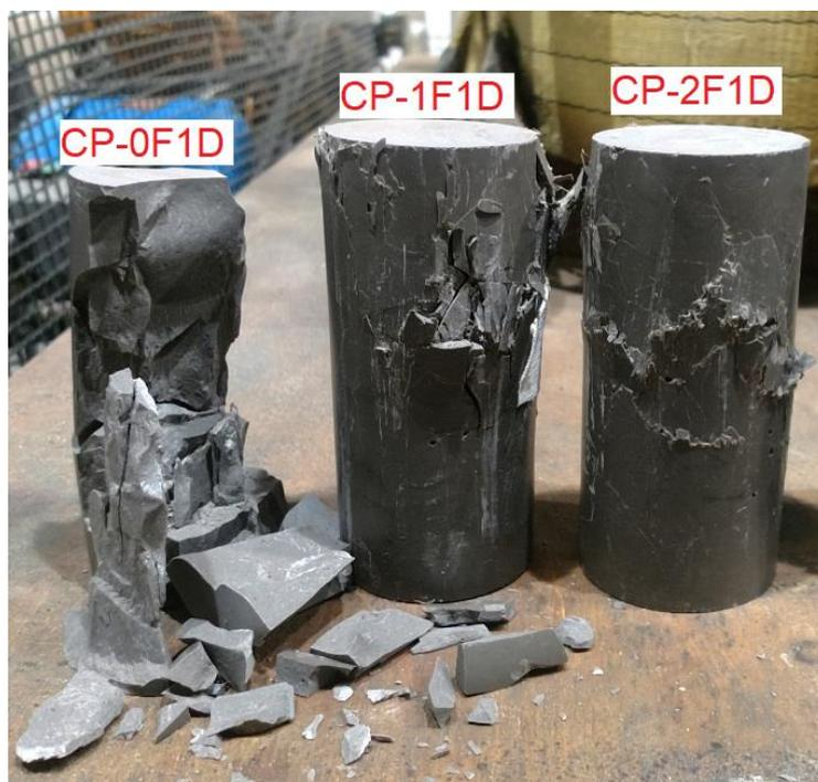
Figura 42: CPs de 1 dia após o ensaio de compressão.
