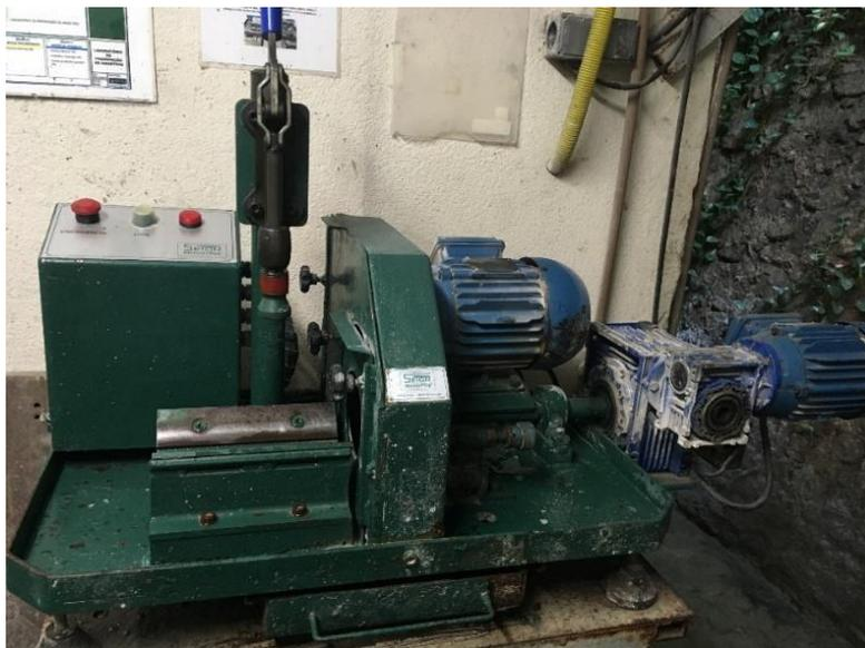
**Figura 36:** Retífica faceadora utilizada na regularização dos corpos de prova.
