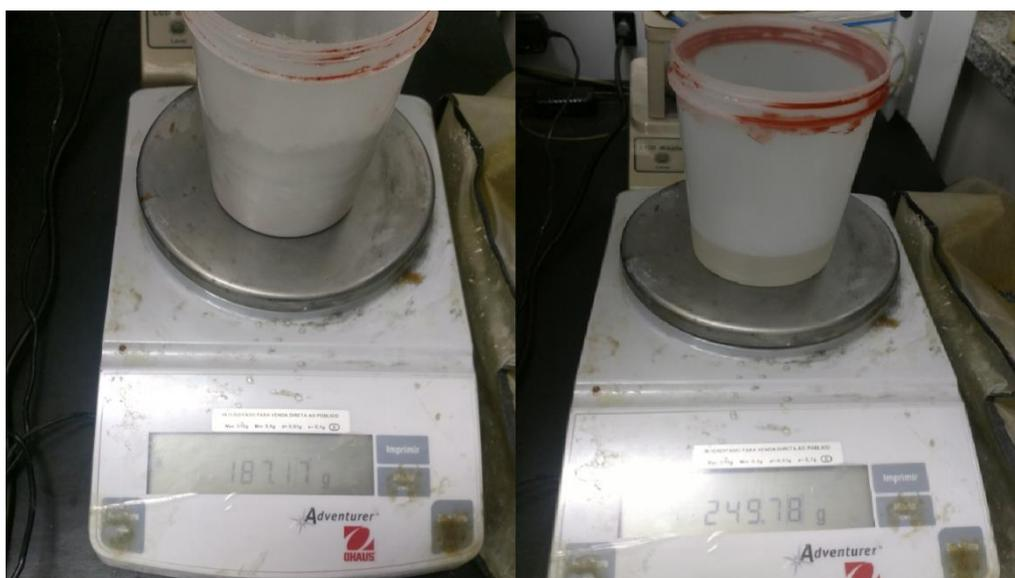
**Figura 21: Pesagem do pó precursor e do líquido ativador.**
