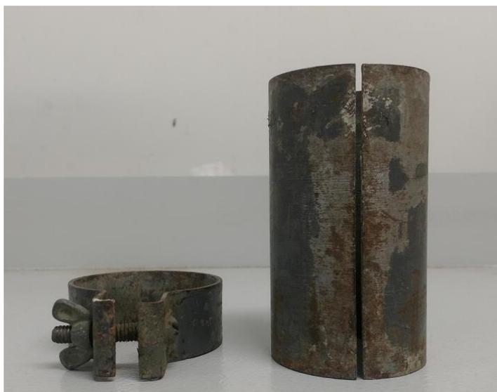
**Figura 27: Molde de ferro cilíndrico para os corpos de prova.**
